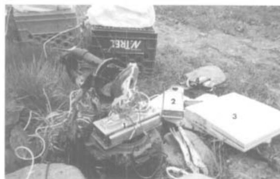
Fig. 4 - Vue du système d'acquisition de données : 1 : CR10 ; 2 : mémoire solide ; 3 : ordinateur portable ; 4 : interface ; 5 : puits d'instrumentation
