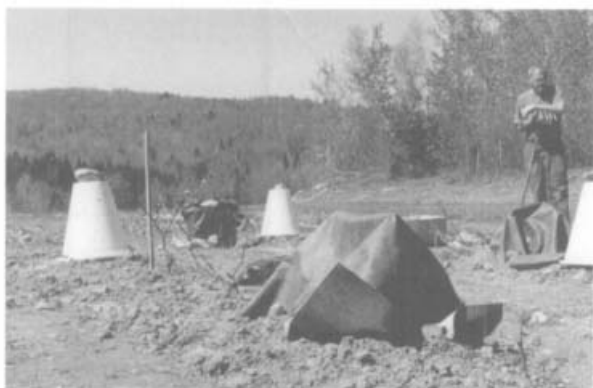
Fig. 3 - Vue du site expérimental avec les toiles géotextiles et les cônes de polystyrène
